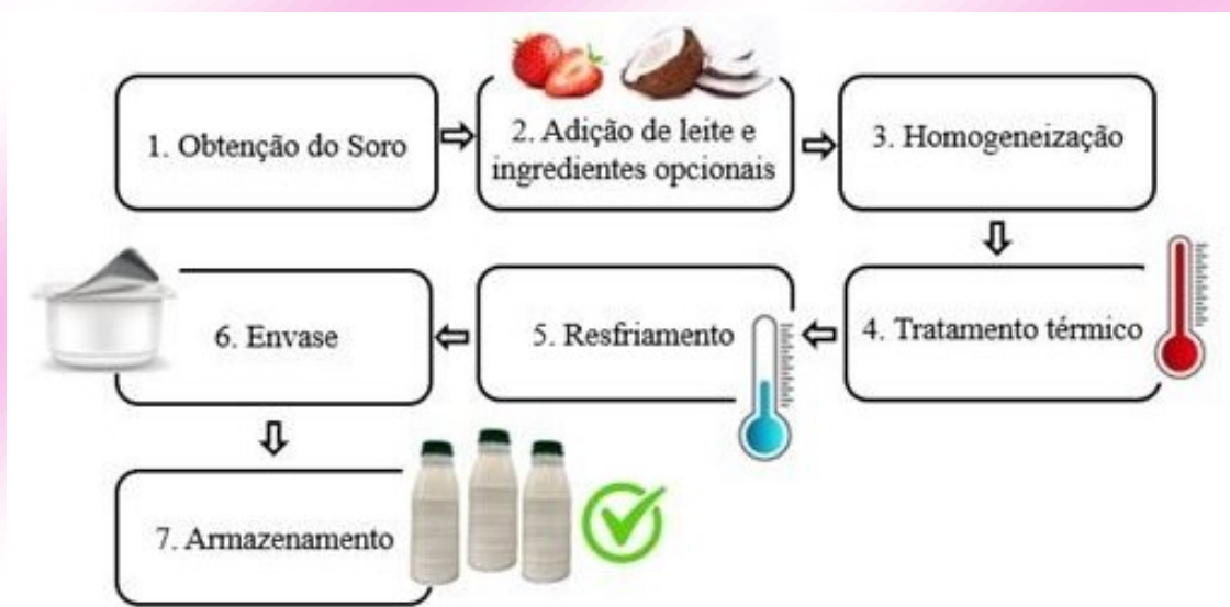
Figura 2. Etapas do Processamento da bebida láctea (MILKPOINT, 2023).
